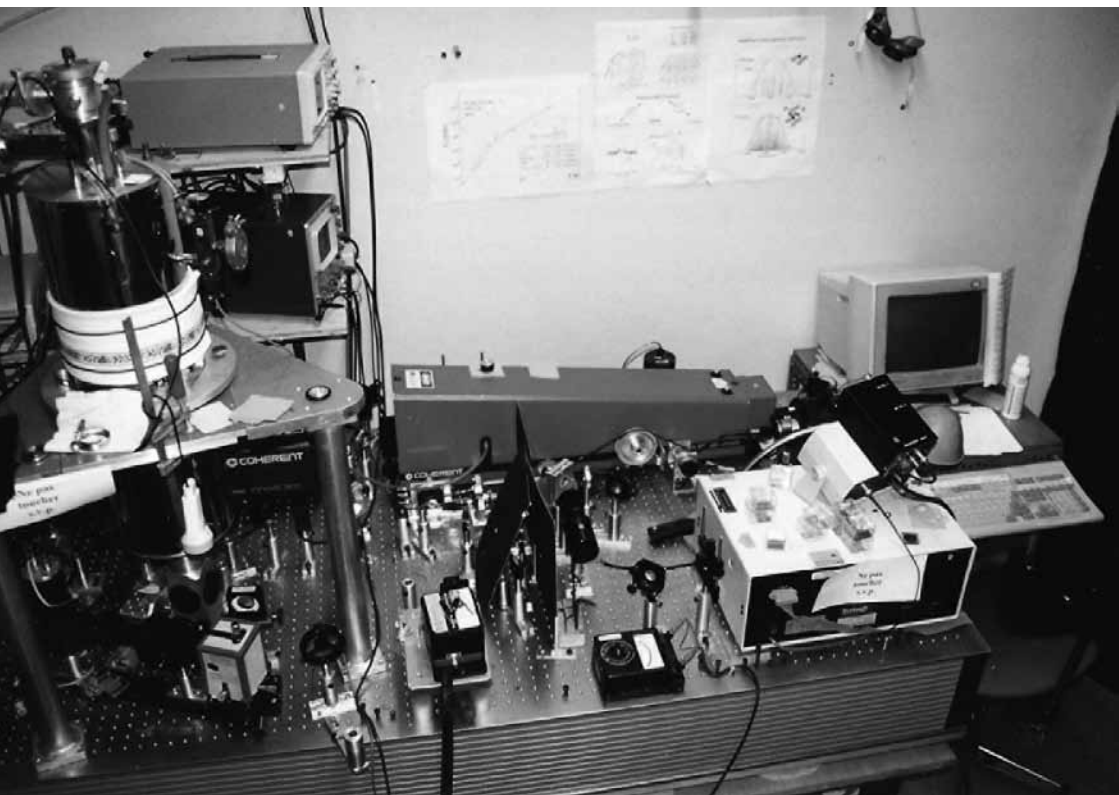
Mit diesem optischen Spektrometer wurden die experimentellen Aspekte der optischen Informationsspeicherung untersucht. Gebaut um 1992.
